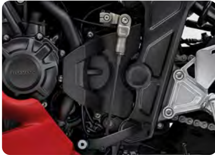
QUICKSHIFTER 08U72-MKN-D50 Erlaubt dem Fahrer, den Gang zu wechseln, ohne den Kupplungshebel zu ziehen oder vom Gas zu gehen. Vereinfacht das Hochschalten und verbessert so das Fahrvergnügen.
