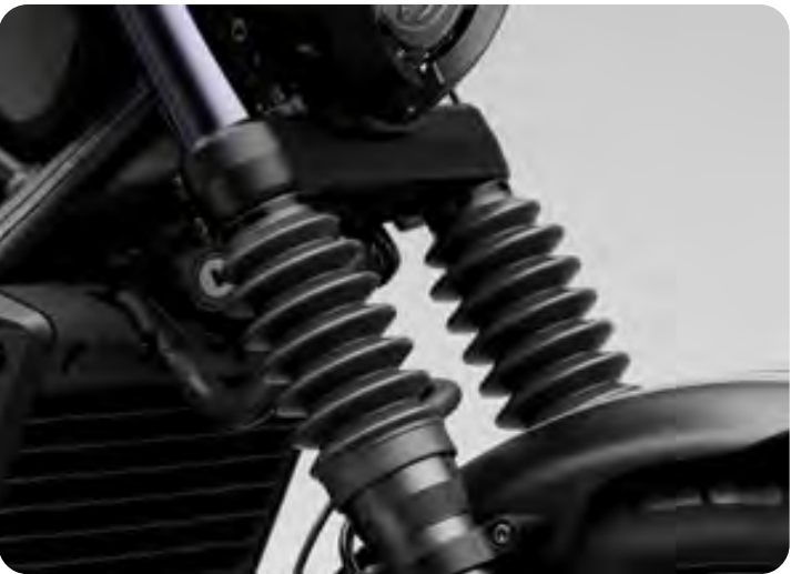
FALTENBALG SCHWARZ 08F70-MLA-AA0 Diese hochwertigen Faltenbälge bestehen aus robustem Gummi und sind an beiden Enden mit Metallbändern fixiert. Sie wurden speziell getestet, um die Gabelrohre vor Kratzern zu schützen und eine reibungslose Federbewegung zu gewährleisten.
