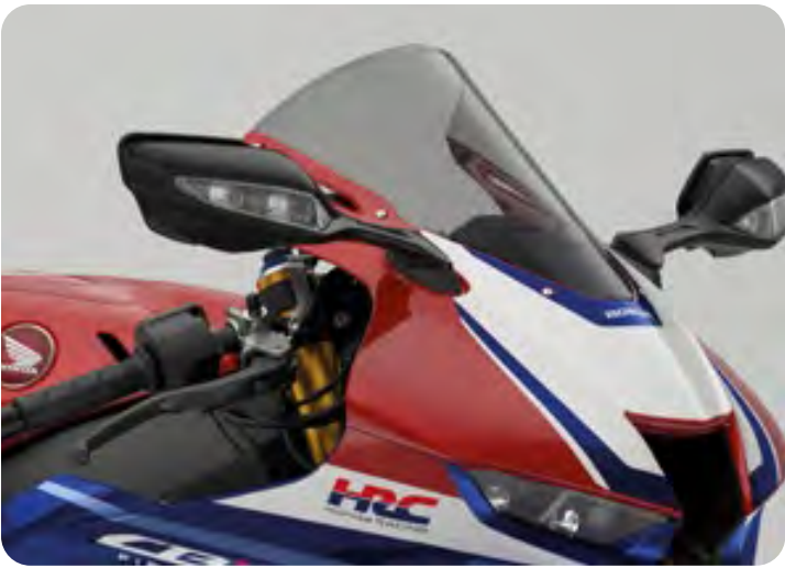
HOHE WINDSCHEIBE 08R70-MKR-D10ZA / 08R71-MKR-D10ZA Die Windscheibe wurde auf Basis intensiver Tests im Windkanal und im realen Testbetrieb designt. Sie vereint erhöhten Windschutz und verbessertes Handling. Die Scheibe überragt die Serienversion in der Höhe um 8 mm und läuft 40 mm weiter vorne aus. Als original Honda Design ist sie vollständig WVTA-zertifiziert und nicht eintragungspflichtig (Bestandteil der EG-BE). Sie ist in zwei Varianten erhältlich: • 08R70-MKR-D10ZA: Getönt • 08R71-MKR-D10ZA: Transparent
