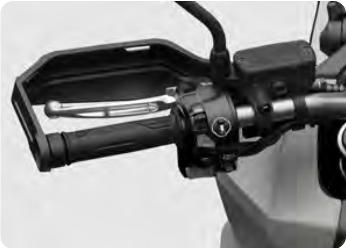
GRIFFHEIZUNG INKL. HALTERUNG 08T70-MKT-D70
