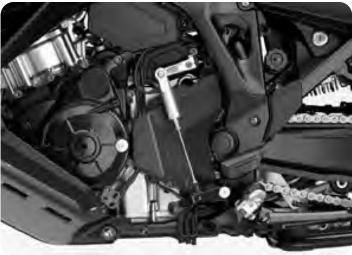
SCHALTASSISTENT 08U70-MLF-E00 Indem er die Intensität des Schalteinputs misst, lässt der Schaltassistent den Fahrer die Gänge wechseln, ohne dass der Kupplungshebel bedient werden muss. Das System kann nach oben und unten schalten und maximiert den Fahrspaß. (Nur für Modelle mit manueller Schaltung)
