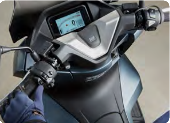
EASY-KIT GRIFFHEIZUNG 08ESY-K1Y-GHS Die Griffheizung wärmt den rechten und linken Griff des Lenkers und sorgt so für ein angenehmeres Fahren an kalten Tagen. Der Schalter zur Bedienung der Griffheizung befindet sich am rechten Lenkergriff. Dieses Kit beinhaltet alle für die Montage notwendigen Zubehörteile.
