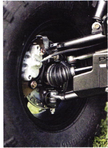
▲ Bremsen oder Rekuperation: Wenn man das Gaspedal loslässt, gewinnt der Ranger Energie zurück. Deswegen muss man nicht aktiv bremsen.
